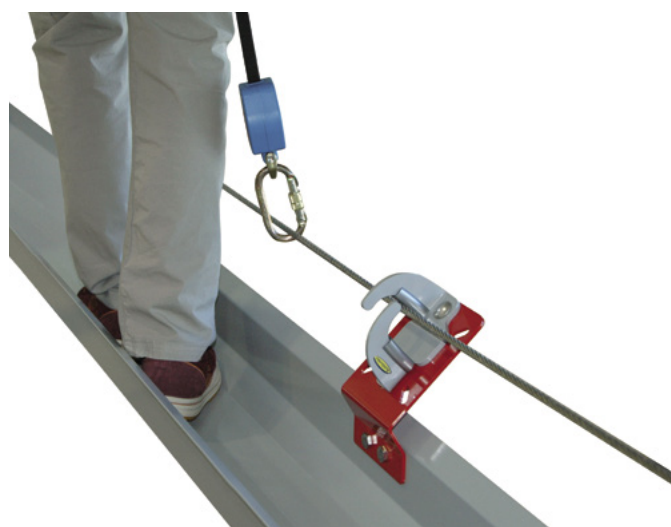
Foto 5. Línea de anclaje EN 795 instalada a exterior de canalón para favorecer el desplazamiento del operario por el propio canalón, Fuente: Creaciones Preventivas.
