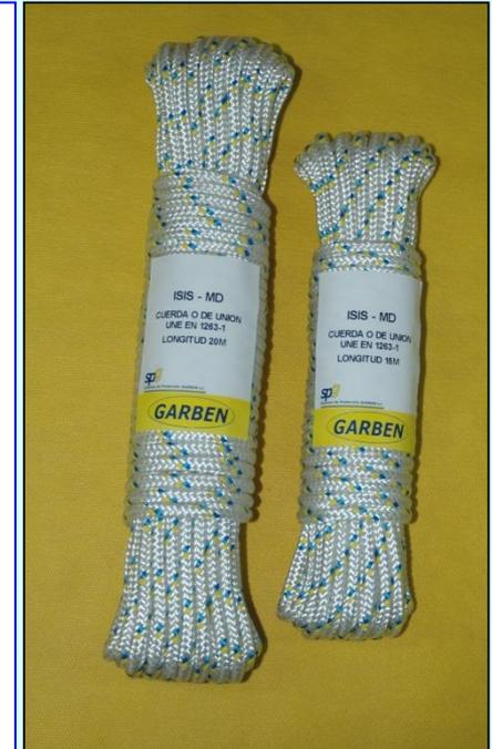
Las redes deben ir unidas malla a malla con cuerda de 7,5 kN y atadas con nudos de reafirmación cada 40 ó 50 cm como máximo (4 ó 5 mallas)
