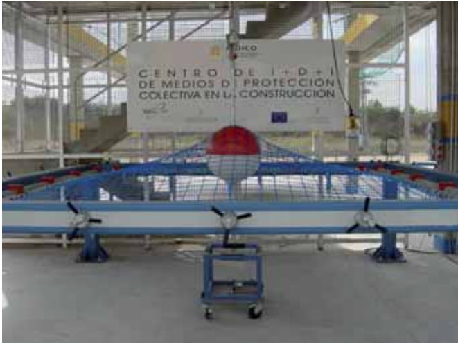
Ensayo estático de resistencia de las redes (energía absorbida hasta rotura) → clasificación Red en A o B
