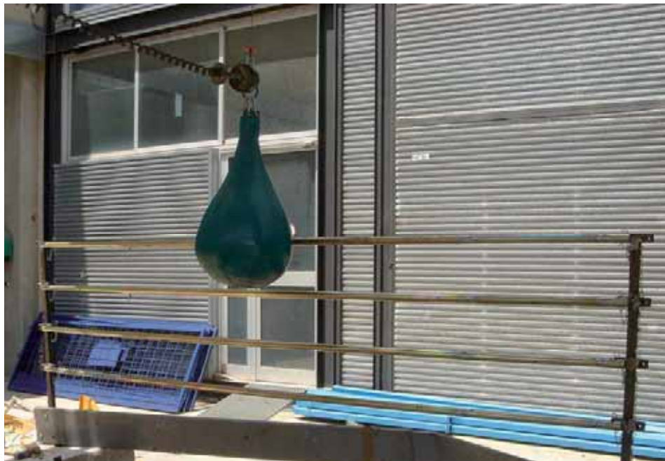
Ejemplo 2. Sistema Provisional de Protección de Borde Clase B, preparado en banco de ensayos, para ser sometido a la energía cinética de impacto en la zona superior del sistema
