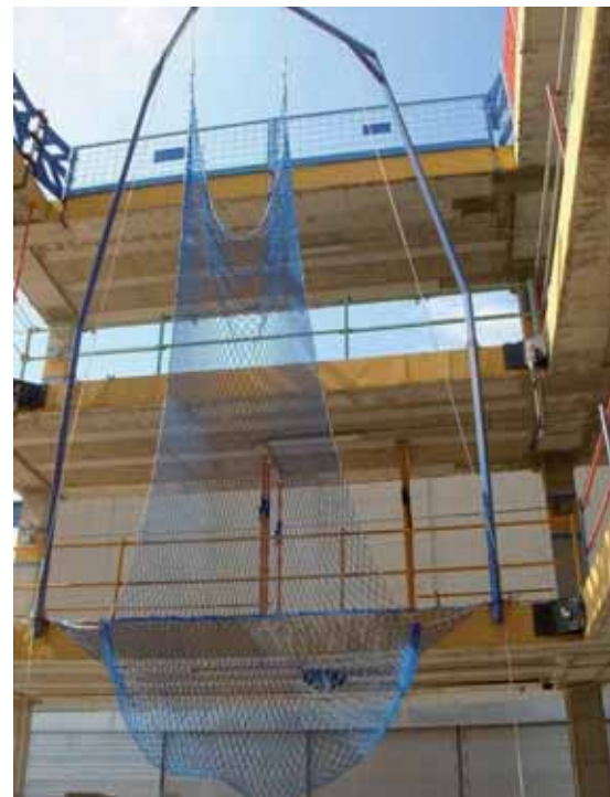
Ensayo dinámico de resistencia sobre Red de Seguridad del sistema V (ensayo satisfactorio tras el 2º impacto)
