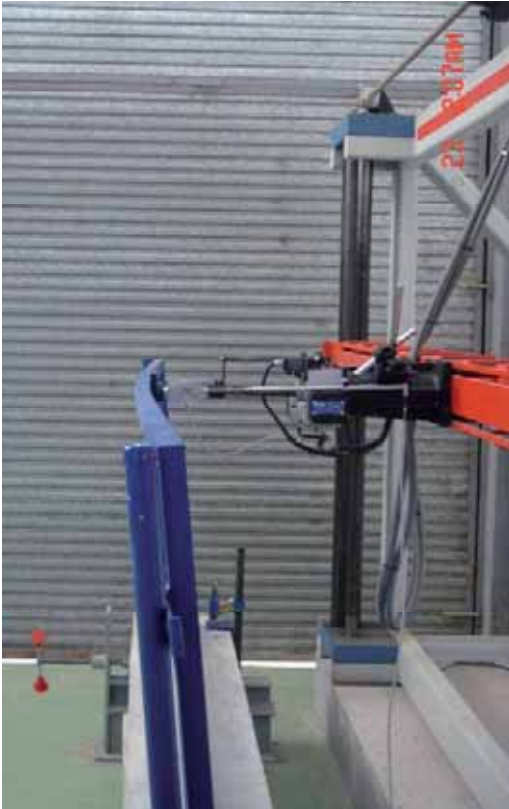
Ejemplo 1. Sistema Provisional de Protección de Borde Clase A, sometido a requisito de resistencia, mediante fuerza estática perpendicular al sistema
