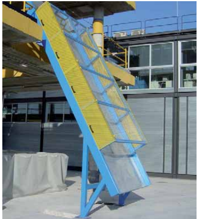
Vista general Plano Inclinado de Impacto, para evaluación experimental de la conformidad de los requisitos de carga dinámica en los "sistemas provisionales de protección de borde clase C"
