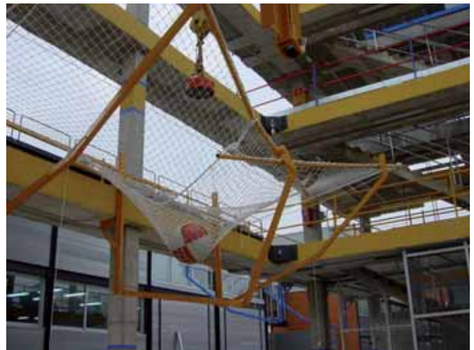
Ensayo dinámico de resistencia Redes de Seguridad del sistema T (ejemplo ensayo satisfactorio sobre configuración módulo compuesto)
