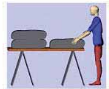
Figura 86 - Soporte para colocar sacos.
