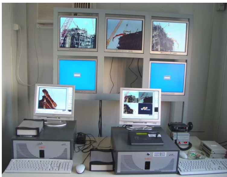
Cabina de control de la obra. Se observan las tres pantallas con la imagen de cada una de las cámaras y a la derecha la emisora de comunicación con el personal en las cestas y los grúas.
