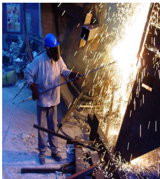
Utilización de lanza térmica para el despiece de
