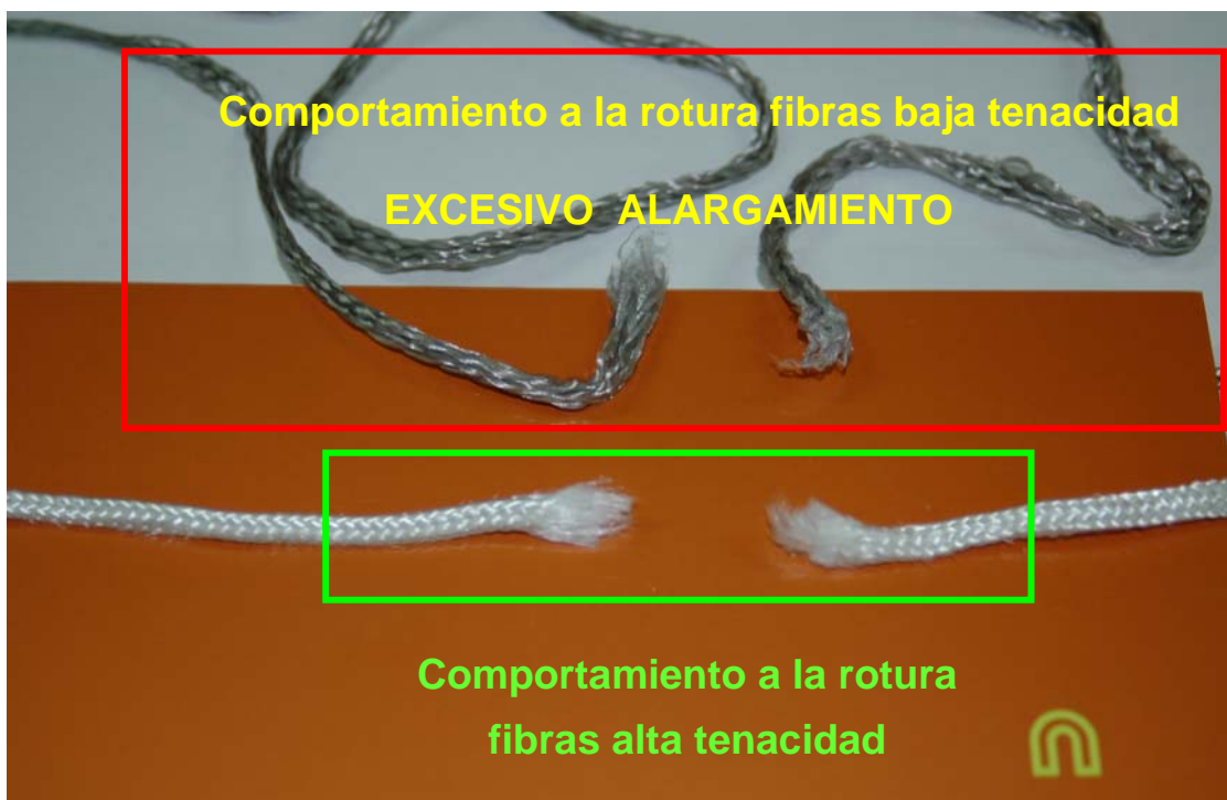
Ensayos carga de rotura – alargamiento
