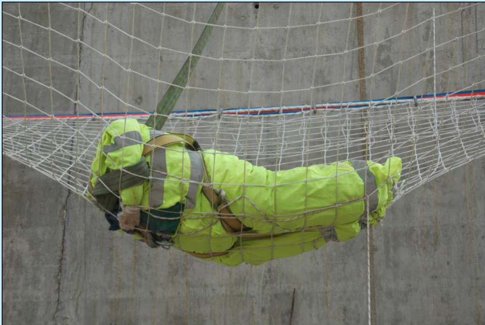
Ensayo del sistema: la masa queda retenida
